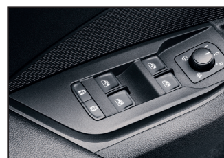
Elektryczna blokada otwarcia tylnych drzwi od wewnątrz
